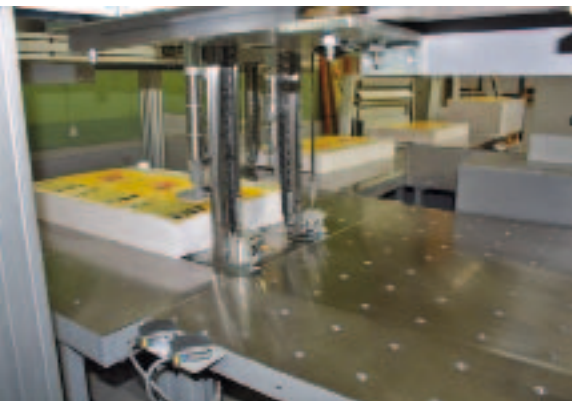
Automatischer Transport in die Schneidemaschine.
