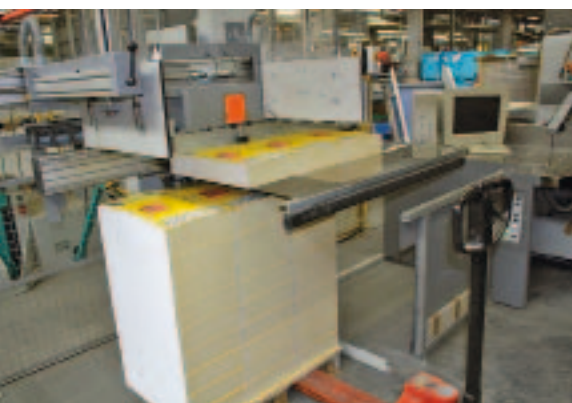
Auf den Paletten können die geschnittenen Lagen automatisch auch besonders hoch abgesetzt werden.
