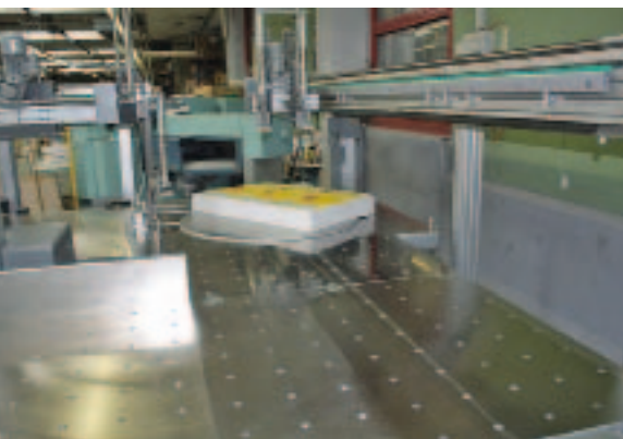
Der Drehteller bringt die vorbereitete Lage in die richtige Position für die Hintertischbeschickung.
